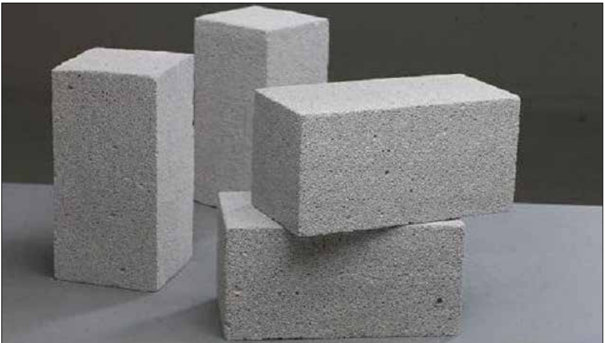
Şekil 93: Tuğla şeklinde hazırlanan perlitlerin görüntüleri
