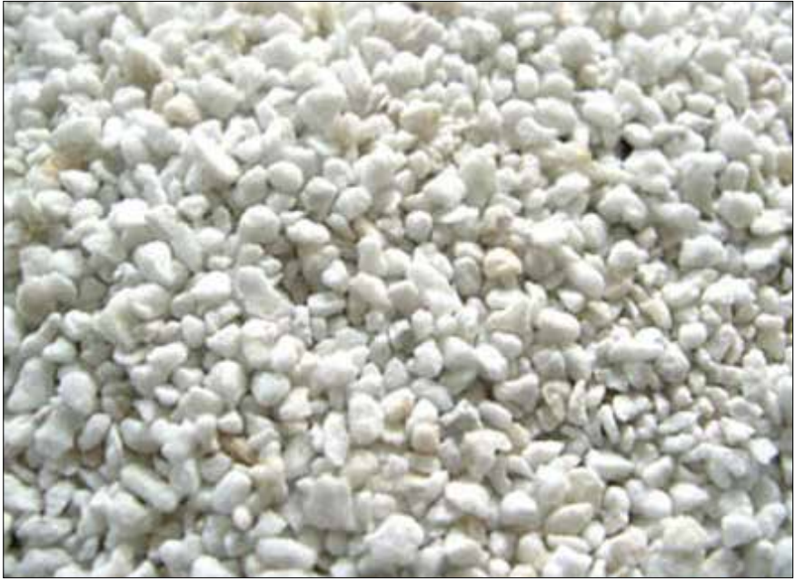
Şekil 89: Volkan camının ısıtılmasıyla oluşan perlitin kırılıp küçültülmüş tanecikleri (Resim Kaynağı: MTA)
