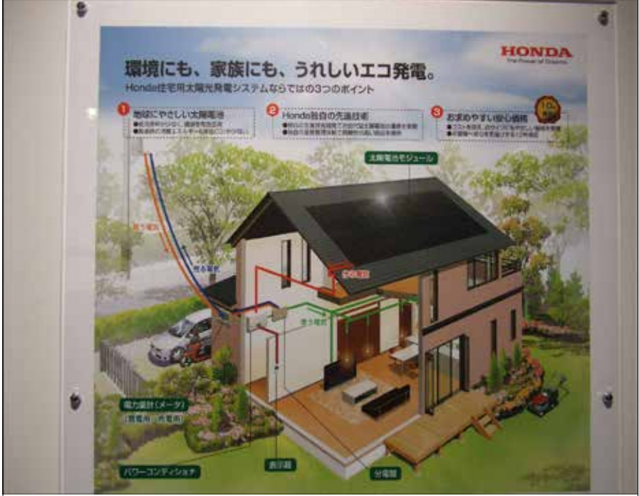
Şekil 17: Evdeki çatılarda üretilen Güneş enerjisinin Devlet interkonnekte sisteme nasıl nakledileceğini gösterir şekil.
