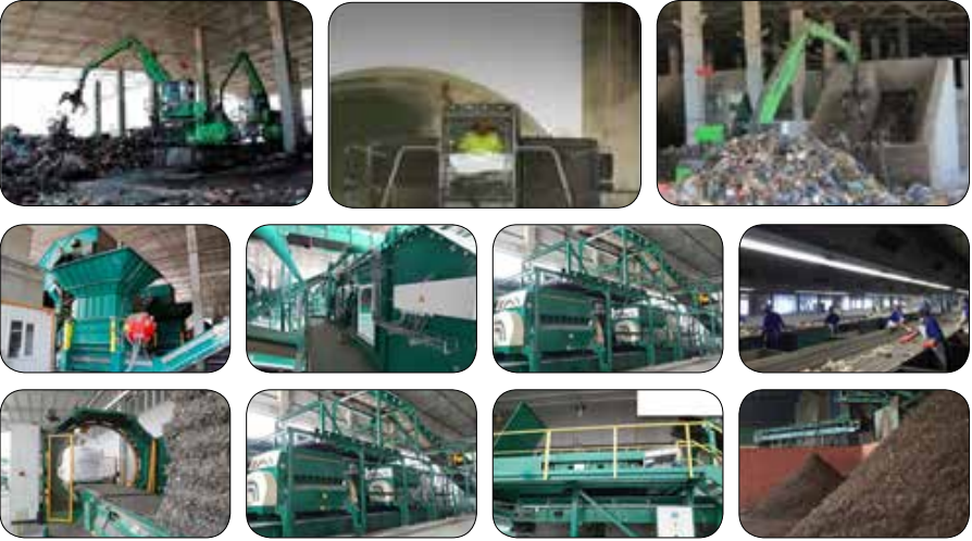
Şekil 52: Şile Kömürcüoba'da bulunan Türkiye'nin ilk Entegre Mekanik Biyolojik İşlem ve Geri Kazanım Tesisi. Bu tesiste, alüminyum, plastik, metal, demir, cam, kağıt ve karton gibi geri dönüşebilen malzemeler geri kazanılmaktadır.
