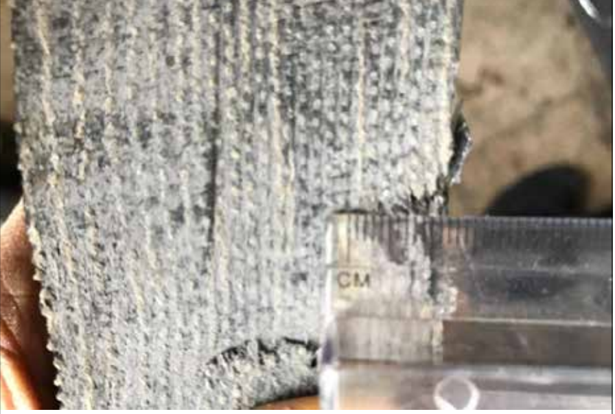
Şekil 74: Kenevirden yapılan yelek üzerine 25 metreden Kaleşnikov uzun namlulu yapılan atışta, sadece 1,7 santim girebildiğini gösteren resim.
