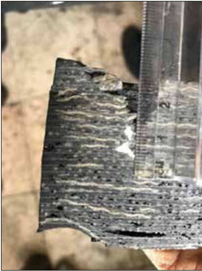
Şekil 73: Kenevirden yapılan yelek üzerine 25 metreden G3 uzun namlulu silahla yapılan atışta sadece 2,5 santim girebildiğini gösteren resim.
