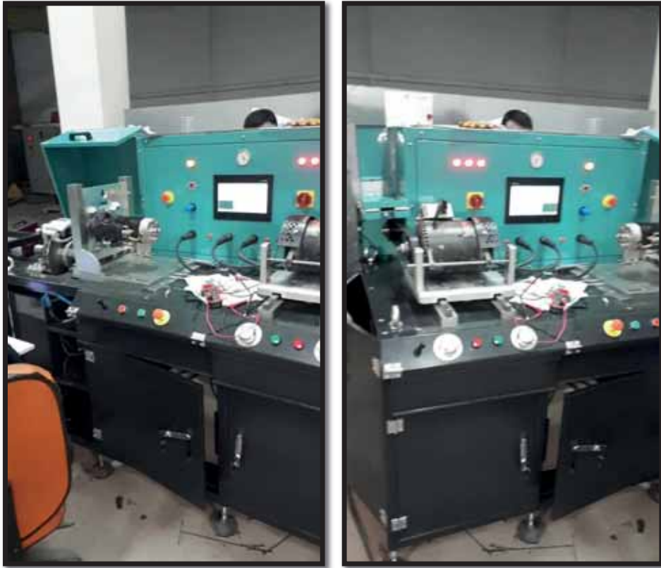
Şekil 136: Türkiye’de üretimi tamamlanan ve hem alternatör hem de marş motoru testi yapabilen prototip tezgah.
