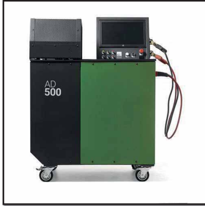
Şekil 135: Sadece alternatör testi yapan AUTO DIAGGER AD500, POLONYA üretimi tezgah.
